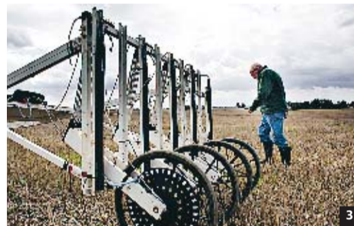
1. Thomas Zitz rattar minitraktorn fram och tillbaka över fältet. Georadarn samlar in data om vad som finns under marken. 2 och 3. Magnetometern dras fram över fälten av en fyrhjuling. Den mäter magnetism och kan avslöja stenar och spår av byggnader. 4. Professorerna Lars Larson och Wolfgang Neubauer studerar mätresultaten på skärmen.
