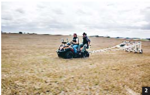
1. Thomas Zitz rattar minitraktorn fram och tillbaka över fältet. Georadarn samlar in data om vad som finns under marken. 2 och 3. Magnetometern dras fram över fälten av en fyrhjuling. Den mäter magnetism och kan avslöja stenar och spår av byggnader. 4. Professorerna Lars Larson och Wolfgang Neubauer studerar mätresultaten på skärmen.
